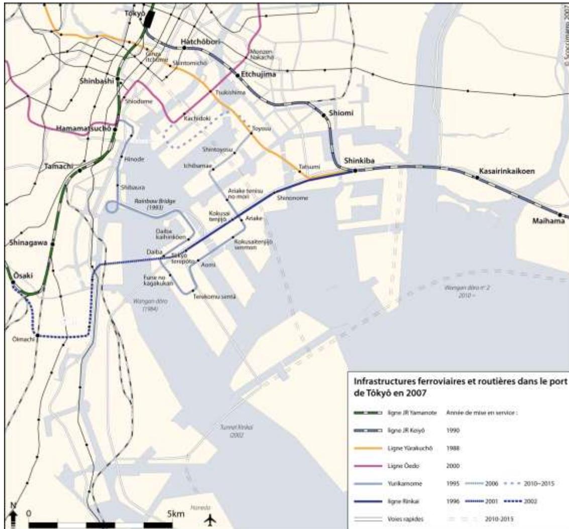
Figure 33 : Les infrastructures de raccordement des terre-pleins du port de Tôkyô depuis 1988.
